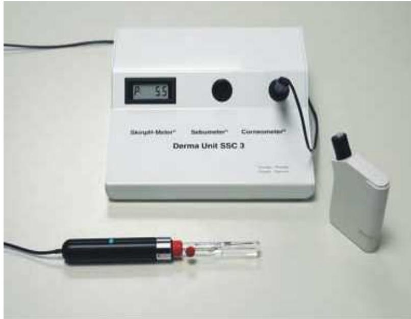
La unidad combinada **Sebumeter / Corneometer / pH meter** es un aparato compacto con una pantalla digital para la medición de **hidratación, grasa y pH en la superficie de la piel**. Incluye un **software** con el cual los resultados de cada medición pueden ser almacenados (junto con datos personales) e impresos. Todo en un solo aparato.
